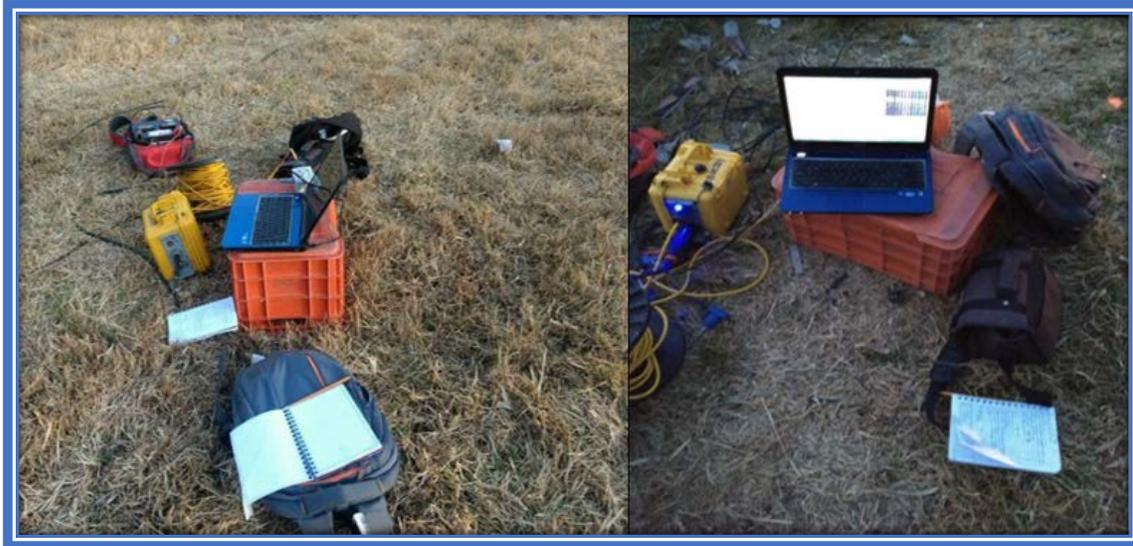
Figura 5.- Sismógrafo de 12 canales tipo Geode de la marca Geometrics. Arreglo lineal de 12 geófonos.
